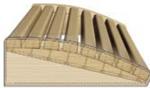
7. Подголовник и лежак склеены и дополнительно скреплены винтами.
