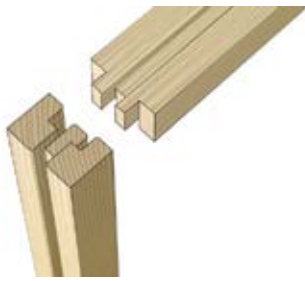
4. Рамы соединением шип-паз для максимальной прочности.
