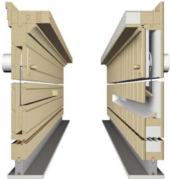
Воздуховоды, справа из массива, слева из отдельных элементов.
